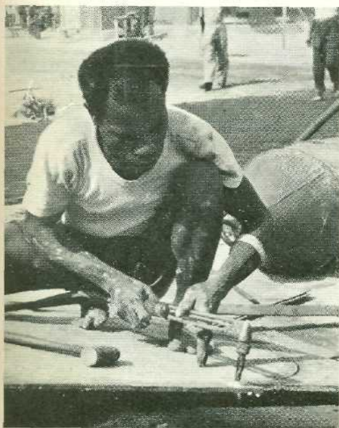
De moderne vakman. Autogeen lasser Moreau aan het cirkelsnijden van stalen platen
